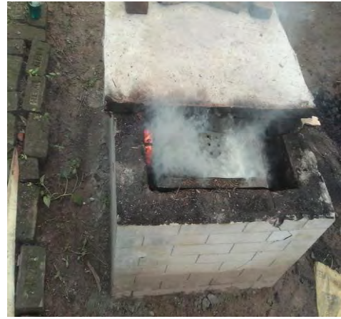
(d) Placing of raw bagasse ash
