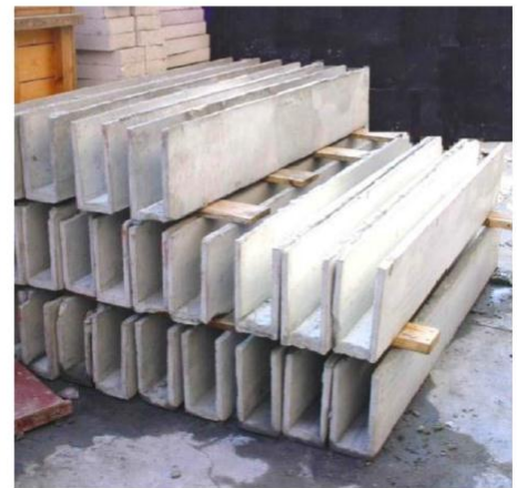
(d) The U-shaped ferrocement forms
